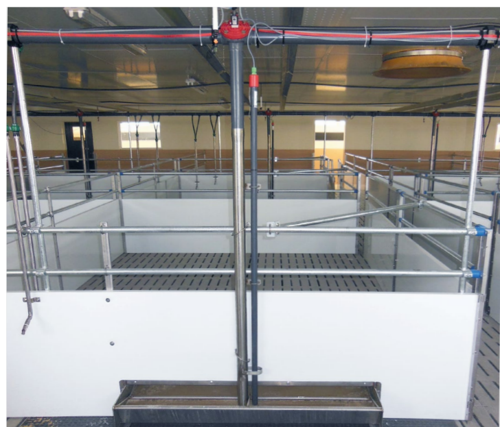
Kurztrug für Sensor-Phasen-Fütterung mit Ventil und SMART 3-WIREBUS
